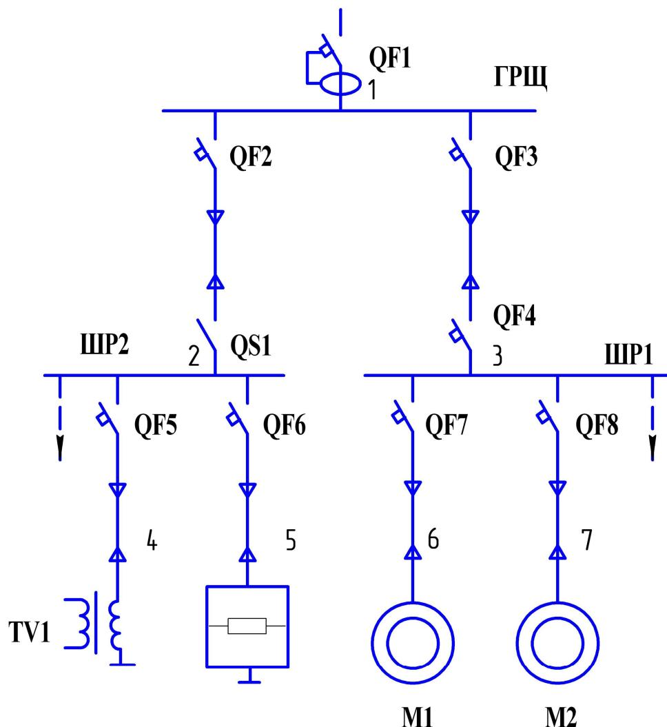
Рис. 1. Схема электрооборудования части электроустановки
